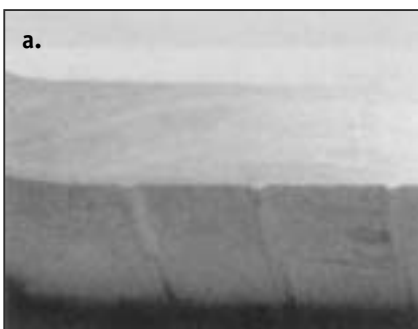
20. ábra. a. Zsugorodás az abroncs felfekvési metszetében (3WH eset) b. A kerék zsugorodásmentes metszete (4WH eset)
