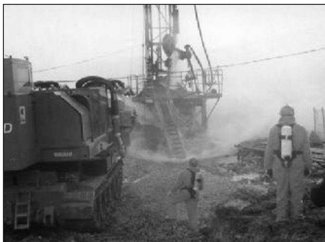
3. kép. Ikerturbó-berendezéssel olvasztják a jeget
