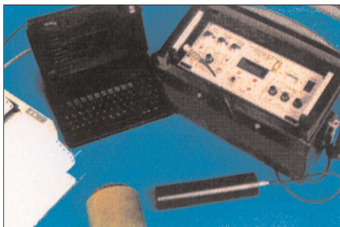
12. ábra. Természetes radioaktivitás- (gamma-) mérés a helyszínen
