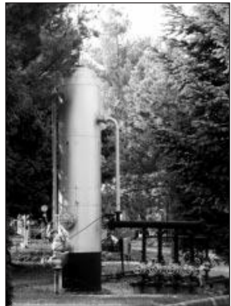
2. kép: Gáz-olaj szeparátor befutósorral és gázmérőhiddal
